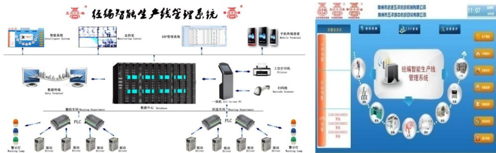
图4-14 经编织造生产线智能物联控制系统结构图
