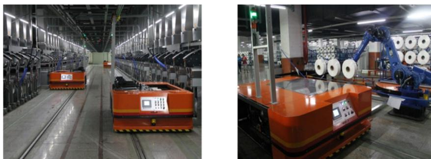
图 2-3 全自动落丝及机器人落卷系统
